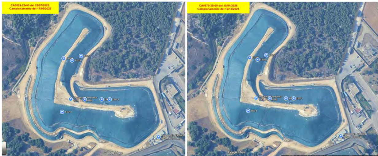
Figura 6: Anno 2025. Emissioni diffuse discarica di servizio soccorso (DGR Puglia n.1483/2018). Postazioni di campionamento concentrazione di odore e sostanze odorogene.
