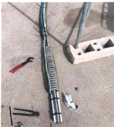
Figura n. 4 - pompa pneumatica e sistema a serpentina
