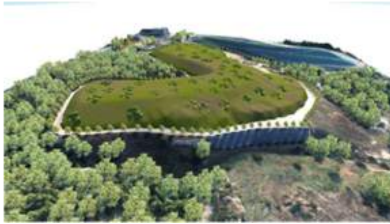
Figura n. 11: Rendering del Piano di recupero e rinverdimento dell'intera discarica con tecniche di ingegneria naturalistica
