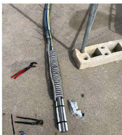
Figura n. 4 - pompa pneumatica e sistema a serpentina
